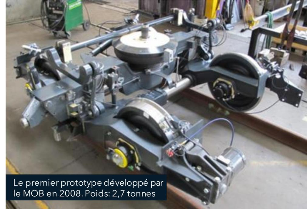
Le premier prototype développé par le MOB en 2008. Poids: 2,7 tonnes
