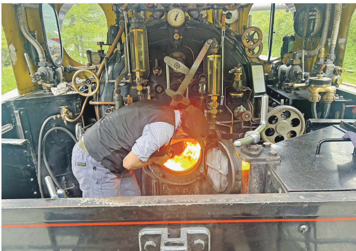
Die Dampflokomotive braucht viel Kohle, der Heizer muss ständig nachschaufeln.
