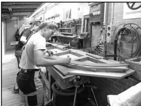
Angehende Zimmerleute arbeiten an den Dachspanten des AB 4463
