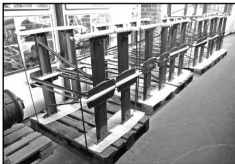
Die lackierten Bankgestelle sind bereit für die Montage der Sitzflächen und Lehnen
