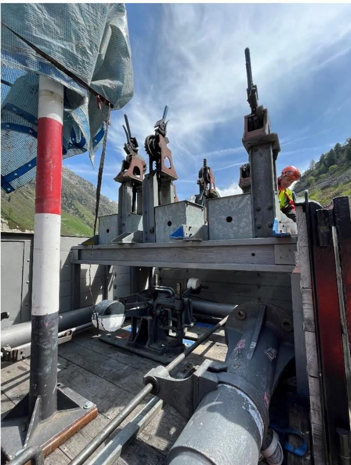
Die Weichenböcke, Signale und Wasserkrane der Station Gletsch und der Bahnübergänge Rotten und Blauhaus im Hochbordwagen, der im Winter in der Remise Gletsch abgestellt ist.
