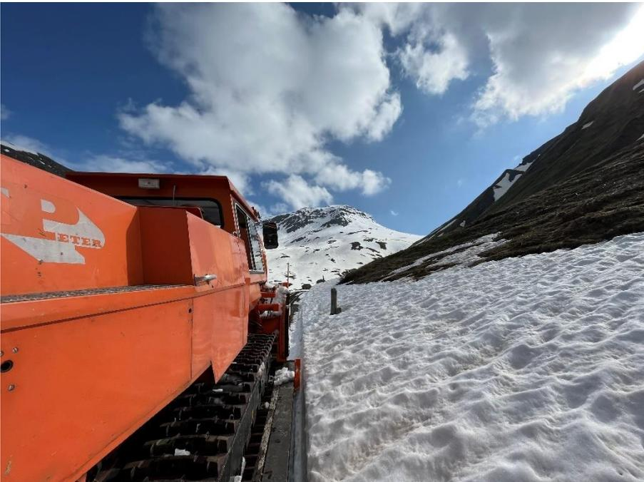
Nach der Räumung des Vorplatzes und des östlichen Stumpengleises der Station Furka, wird die INTRAC Schneefräse auf den Tiefgänger verladen und nach Realp überführt.
