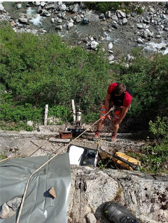
Blick von der Oberkante der Stützmauer zur Reusssohle. In der Bildmitte findet sich das zylindrische Ankerprüfgerät.
