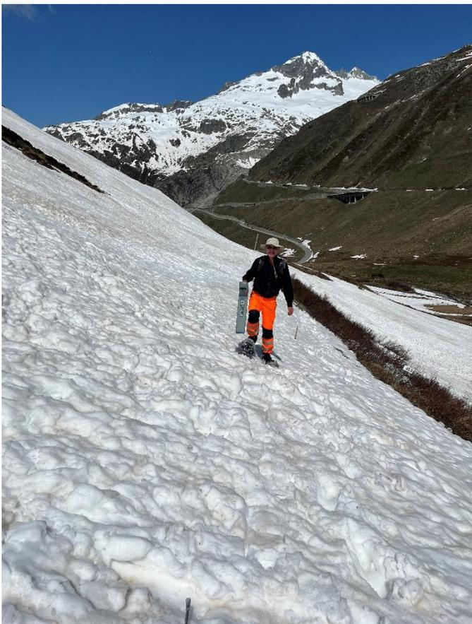
Nach einer kurzen Erst-Instruktion beim Bahnübergang Furkastrasse misst Hans-Ludwig Schneider mit dem geoelektrischen Messgerät selbständig die Gleisachse zwischen dem Bahnübergang und der Station Muttbach-Belvédère ein.
