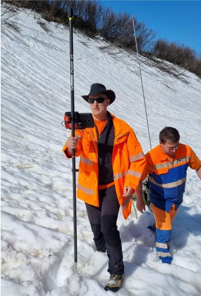
Luc Wullschleger und Michael Bühler testen das neue GPS-basierte Messgerät zum Einmessen der Gleisachse.
