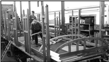
Probeaufbau des Wagenkastens
