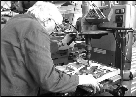
Bohren der Ablage-Konsolen
