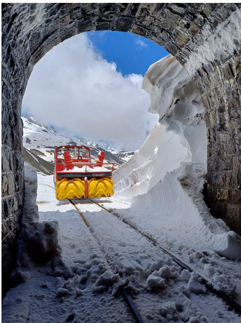
Nach dem Fussmarsch durch den Scheiteltunnel werden wir am Ostportal von der HGm 51 mit Anbaufräse «begrüsst».
