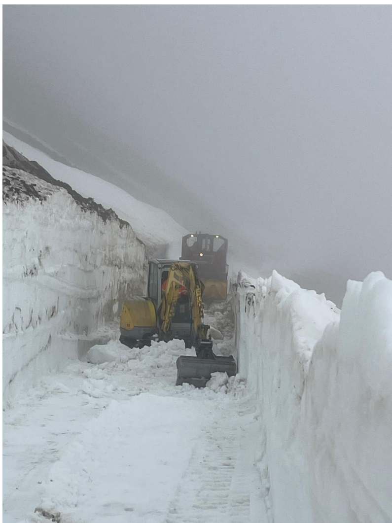
Der Bagger muss den an der Basis stark vereiste Schnee aufbrechen. Bild: Patrick Smit
