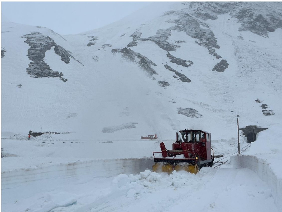
Die HGm 51 mit Anbaufräse räumt dem mit dem Bagger aufgebrochenen vereisten Schnee vom Gleis 1 des Bahnhofs Muttbach-Belvédère weg. Bild: Patrick Smit
