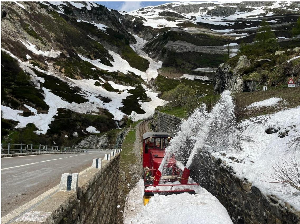
Um die Mittagszeit schliesst die HGm 51 mit Anbaufräse die Schneeräumung der Bahnleise beim bergseitigen Portal des Kehrtunnels ab.
