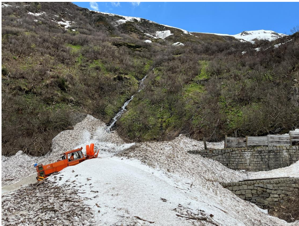
Erst nach Montage von Schneeketten auf den Raupen der INTRAC Fräse schafft es Stephan Stauber, dem Lawinenkegel zu überwinden. Bild: Patrick Smit
