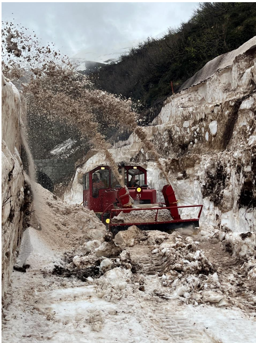
Die HGM 51 mit Anbaufräse mitten im rund 5 m mächtigen «dreieckigen» Lawinenkegel zwischen Tunnel 3 und Tunnel 2. Bild: Patrick Smit
