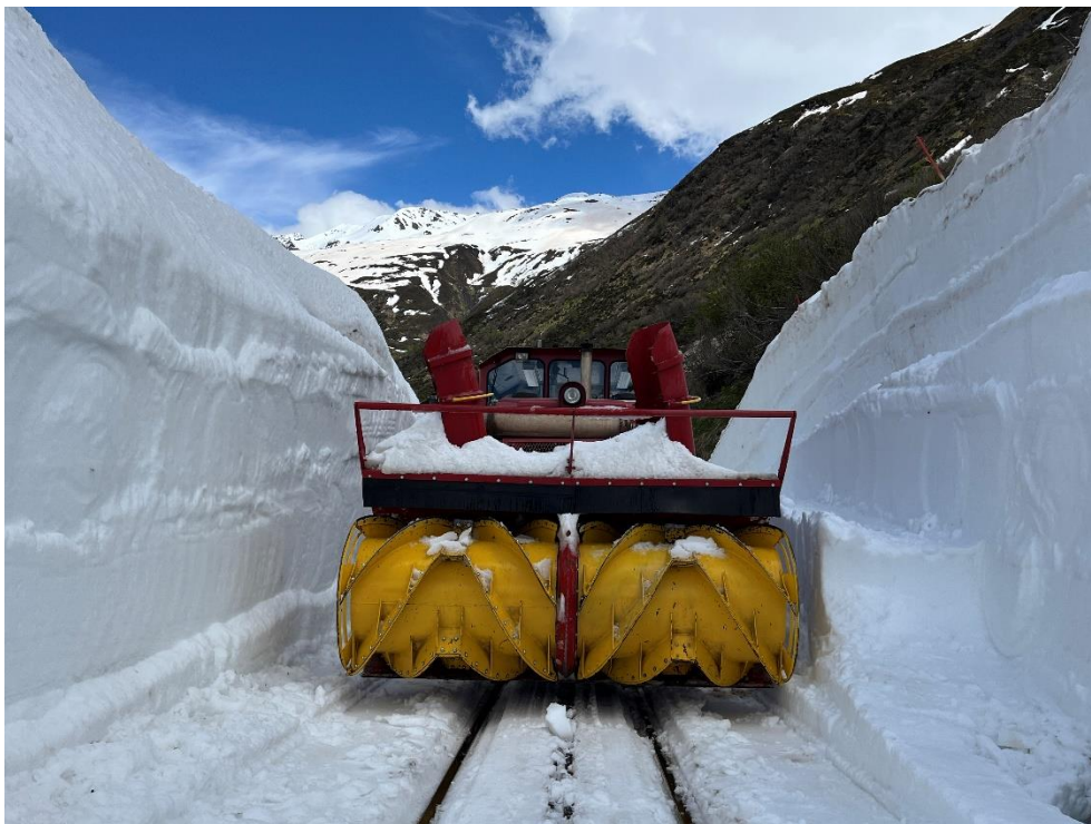
Die HGm 51 mit Anbaufräse zwischen Tunnel 1 und Tunnel 2.
