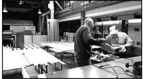
Zuschneiden und Layout des Dachtäfers
