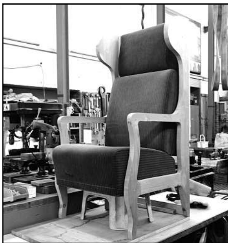
Mustersitz 1. Klasse als Vorbild für die Fertigung der Gestelle aus edlem Nussbaumholz
