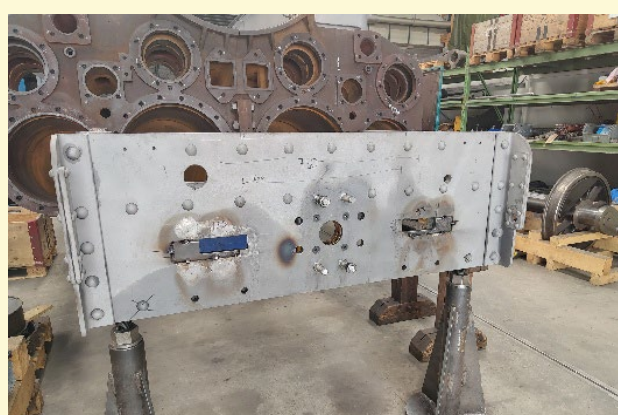
Anpassung der Öffnungen für die Zughaken. Die Bleche sind eingeleftet.
