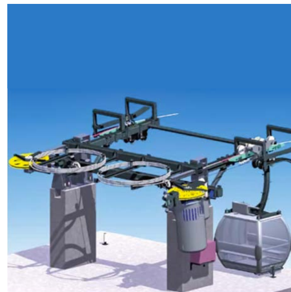
Standardisierte Antriebsstation der Kompaktseilbahn
