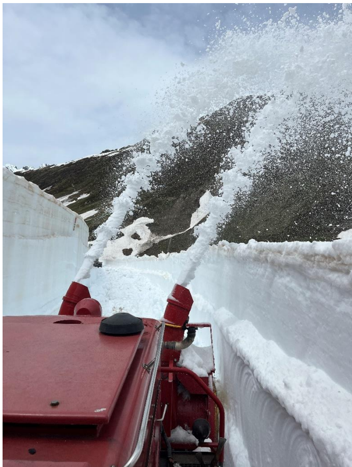
Die HGM 51 mit Anbaufräse in der Wächte unterhalb des Steinstafelviadukts. Blick vom Lokführerstand. Bild: Patrick Smit
