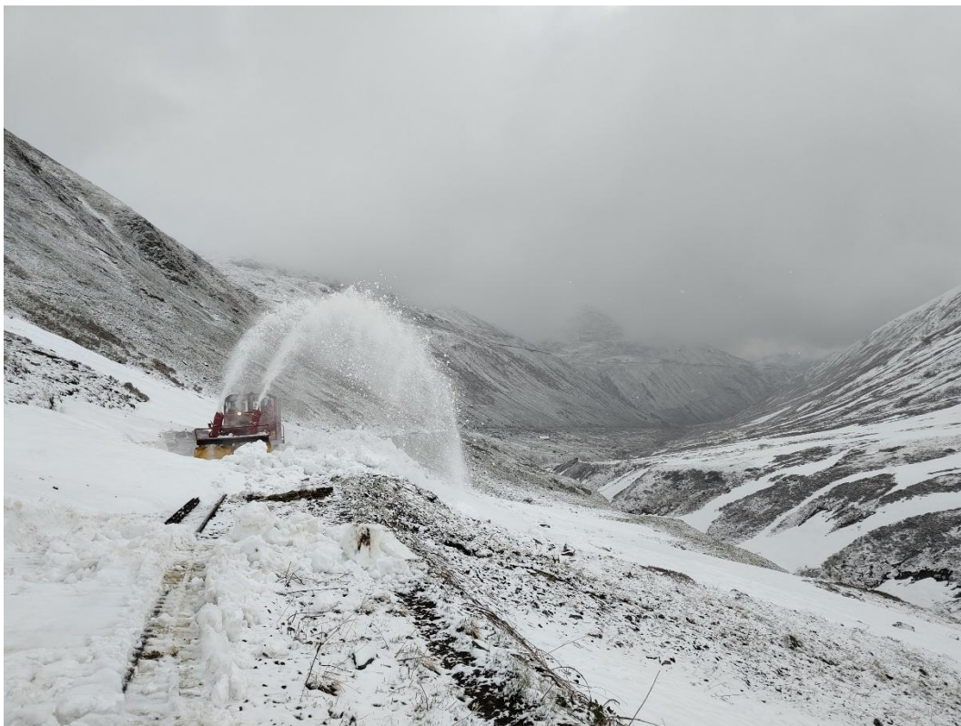
Schneeräumung mit HGM 51 mit Anbaufräse zwischen Sidelenbrücke und Bahnhof Furka.
