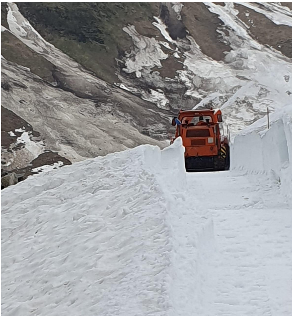
Langsam, aber stetig «frisst» sich die INTRAC Raupenfräse durch den pickelhaften Schnee zwischen BUe Furkastrasse und dem Westportal des Scheiteltunnels.
