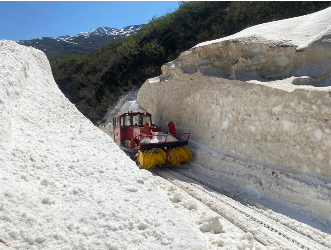
Die HGm 51 mit Anbaufräse zwischen den Altseentuntunnels II und I.
