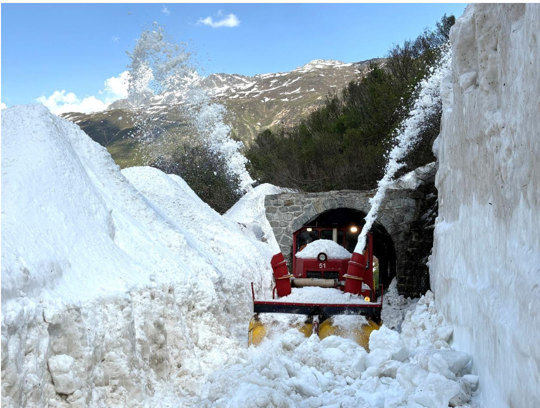
Langsam fräst sich die HGm 51 mit Anbaufräse durch den restlichen Lawinenschnee vor dem Altsenntumtunnel I.
