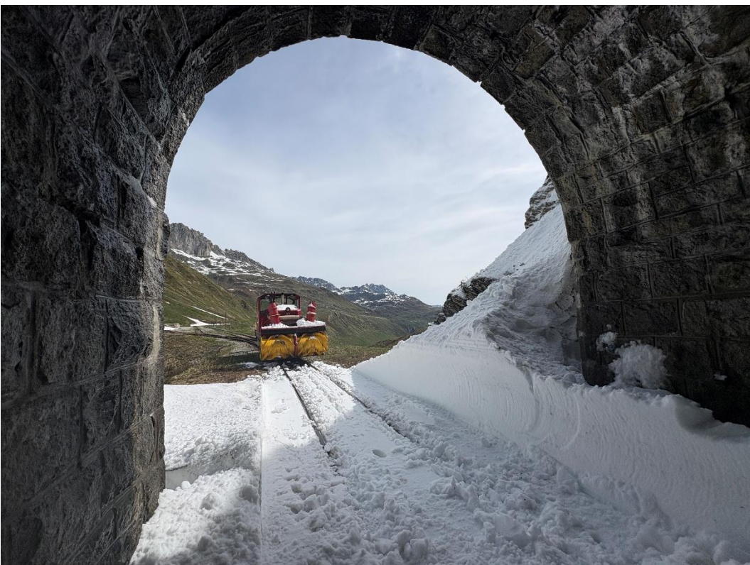
Die HGm 51 mit Anbaufräse erreicht das Ostportal des Scheiteltunnels. Bild: Patrick Smit.
