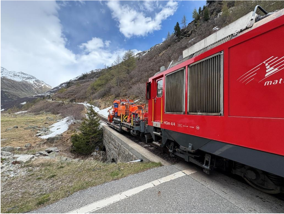
Die HGM 4/4 61 bringt die INTRAC Schneefräse zum nächsten Einsatzort unterhalb des Bahnübergangs Furkastrasse.
