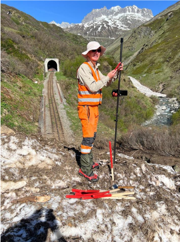
Hans-Ludwig Schneider beim Einmessen der Gleisachse mit dem neuen GPS-Messgerät. Bild: Luch Wullschleger.
