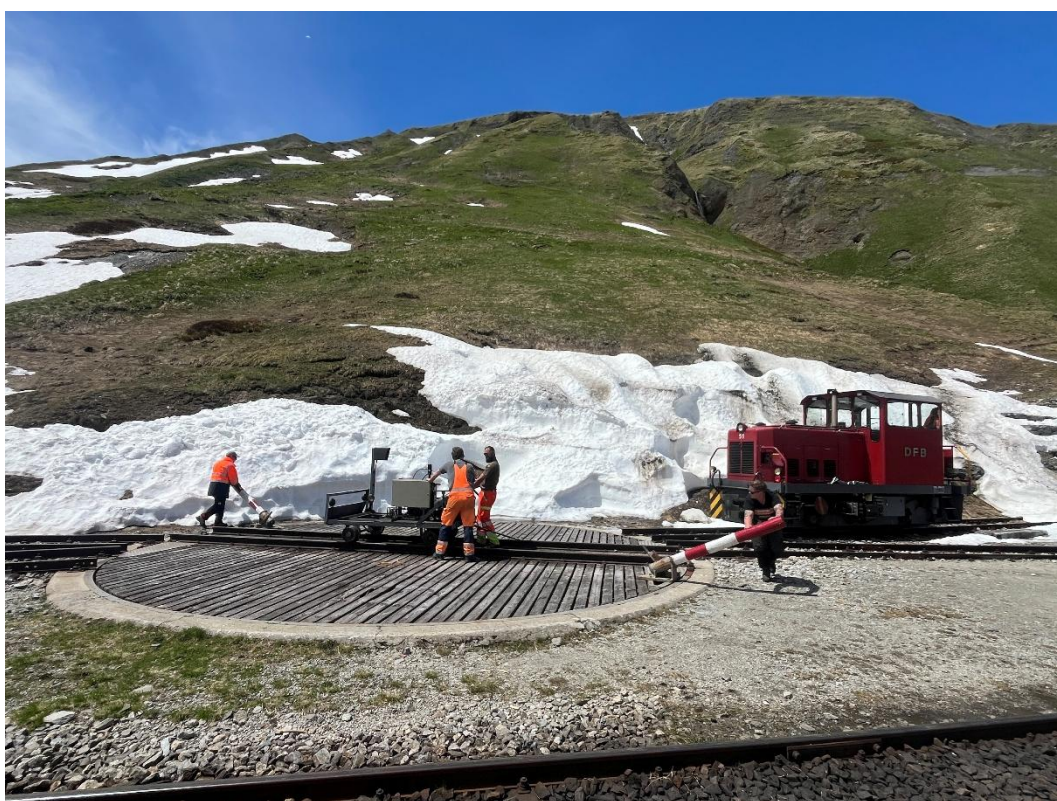
Wenden des (ungebremsten) Schmierwagens und der HGM 51 auf der Drehscheibe Furka für die Talfahrt Richtung Oberwald. Bild: Patrick Smit
