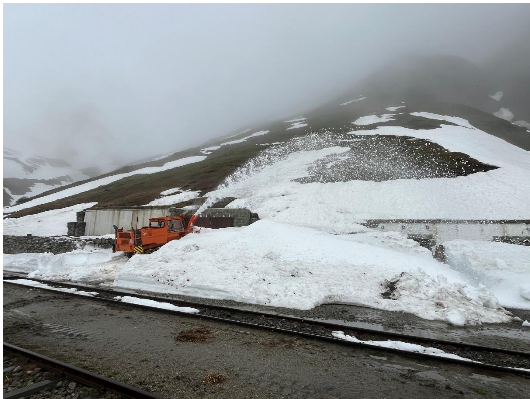
Stephan Stauber nimmt sich mit der INTRAC Raupenfräse den Schneemassen auf dem Vorplatz des Bahnhofs Furka an.
