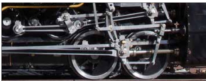
HG 4/4: Antrieb für Adhäsion und Zahnrad Foto: DFB-Archiv
