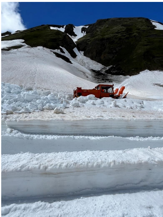
Blick vom geräumten Gleis 2 Richtung Bahnhofsgelände. Stephan Stauber's INTRAC Raupenfräse zieht 6 m höher ihre Bahn. Bild: Patrick Smit
