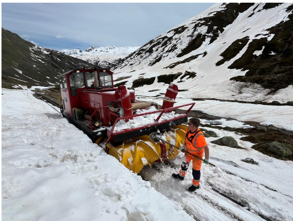
Der nasse und schwere Früh- jahrsschnee verstopft regel- mässig die Kamine, die Thilo Fock (Fräsmaschinist) und Pat- rick Smit (Lokführer) jeweils mühsam ausräumen müssen. Bild: Patrick Smit
