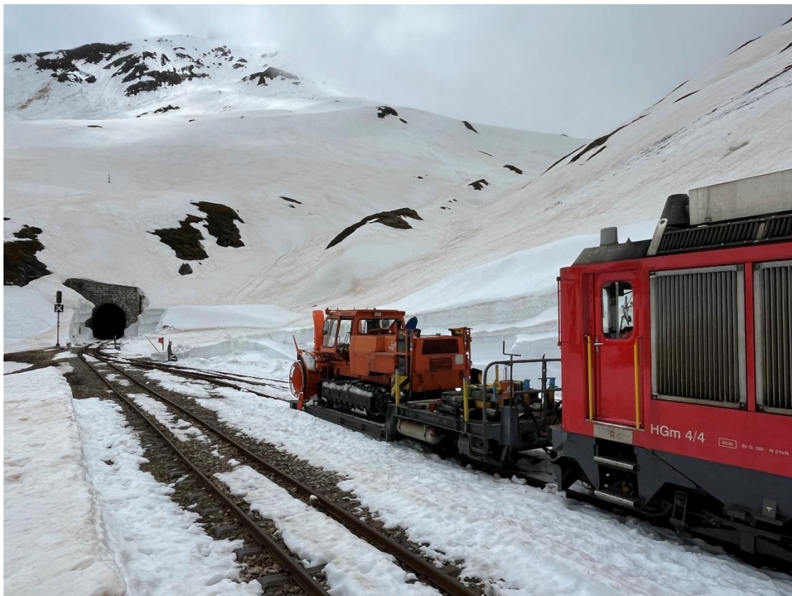
Nach dem Mittagessen verladen wir die INTRAC Rau- penfräse von Stephan Stauber zwecks Überfuhr durch den Scheitel- tunnel nach Mutt- bach-Belvédère auf den Tiefgänger, Bild: Patrick Smit
