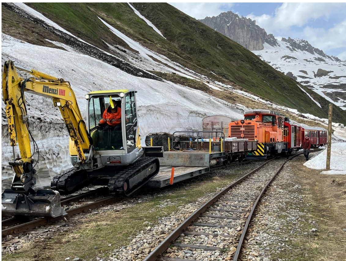
Nach der Räumung des Lawinenkegels überführen Marcel Gwerder und Oliver Rusterholz mit der Gm 3/3 «Moyse» den Bagger nach Muttbach-Belvédère.
