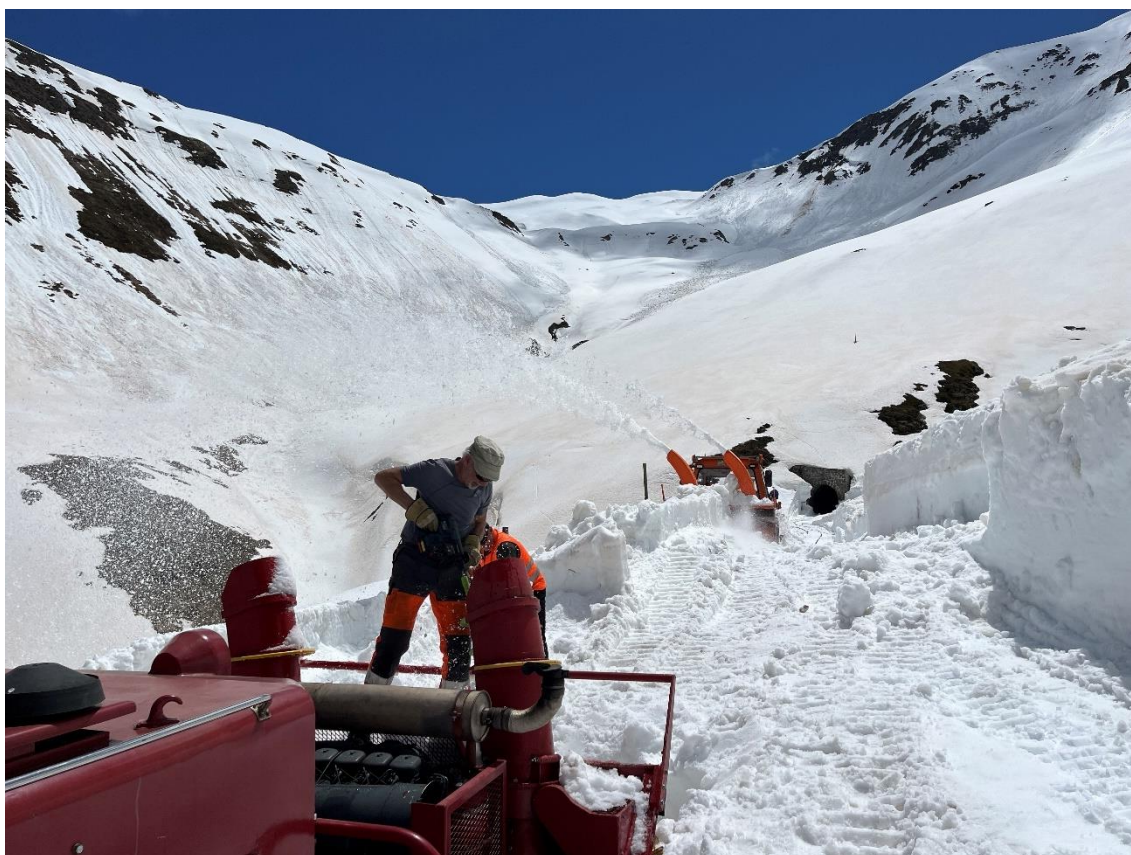
Der schwere Schnee verstopft regelmässig das Kamin der Anbaufräse. Ernst Demonti beim «Entstopfen» der Kammine.
