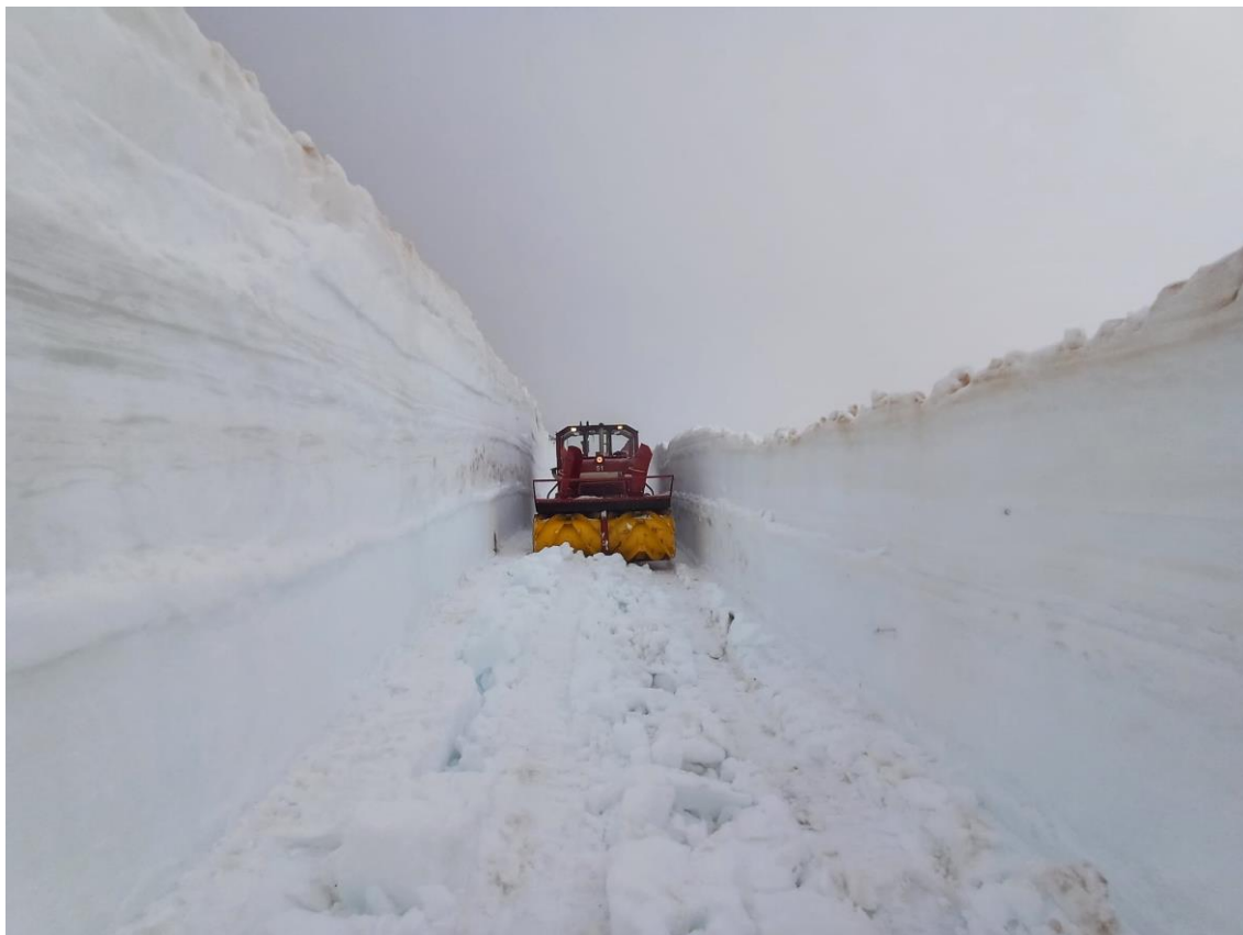
Erst danach vermag die HGm 51 mit Anbaufräse den Schnee wegzufräsen.
