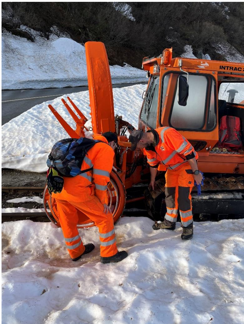
Martin Wieland (Maschinist) instruiert «seinen» Maschinenbegleiter (Daniel Brand) betreffend Einweisung der INTRAC Raupenfräse auf den Schienen.
